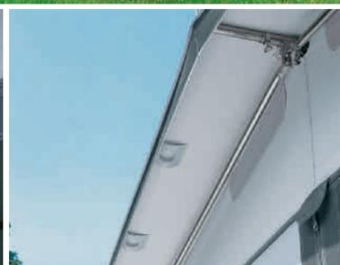
▲ Giebelstangen im Vorzeltvordach fixieren das Sonnendach und sorgen für eine optimale Passform.
