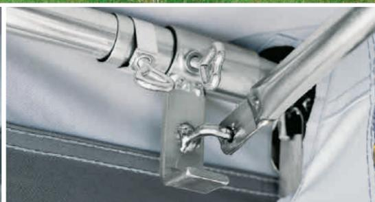
▲ **3 Spezialadapter**, auf die Gestängewinkel aufgeschoben und auf diesen dann fest fixiert, bilden die Basis dieser universalen und kompakten Lösung. Eine sichere Verbindung!
