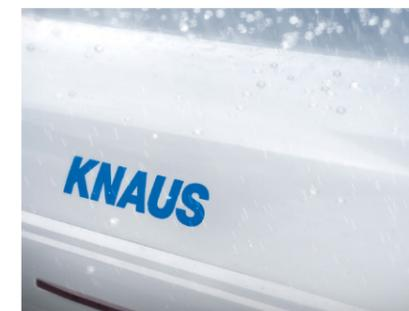
Für maximalen Hagelschutz verbauen wir ein **High-Strength GFK-Dach** mit einem fast drei Mal so hohen Glasfaseranteil wie bei Standard-GFK.
