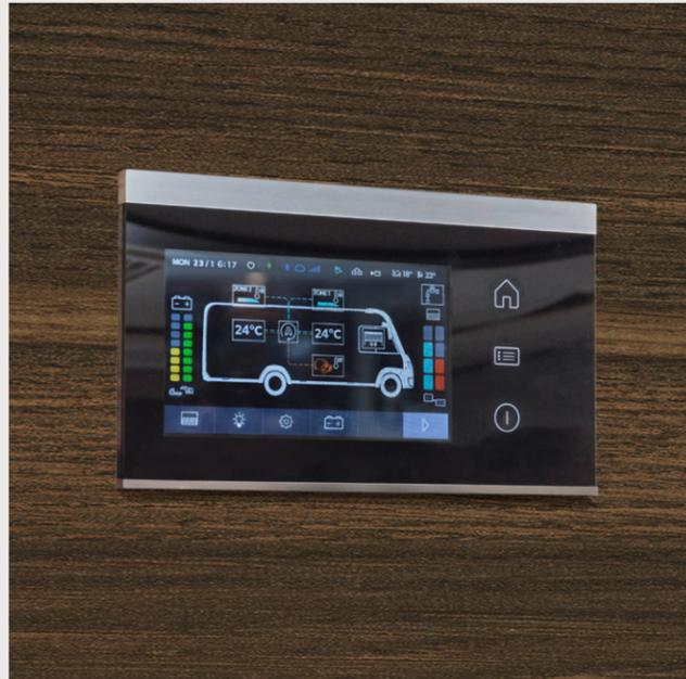
**Intuitive Technik.** Mit dem Touch-Control-Panel ist die zentrale Steuerung der technischen Einheiten besonders leicht und bedienerfreundlich. Unser Bedienpanel mit 4,3 Zoll kapazitivem Touchscreen ist die angenehmste und einfachste Art sämtliche Funktionen des Fahrzeugs zentral zu steuern. Wie ein Smartphone kann es intuitiv durch Berühren des Bildschirms gesteuert werden. So sehen Sie die Temperatur im Fahrzeug oder Füllstände auf einen Blick (modellabhängig/optional).
