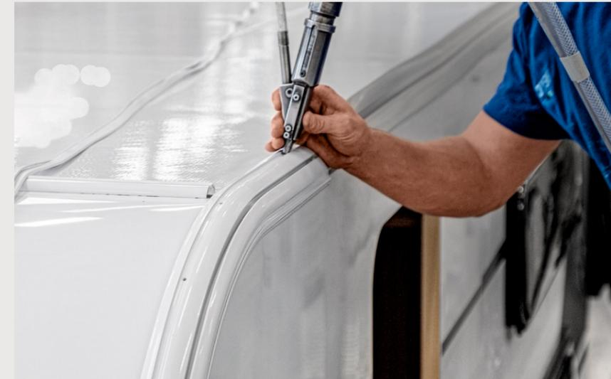
**Stabiler Pro.Tec Frame.** Der Pro.Tec Frame ist eine besonders massive Aluminiumprofil-Leiste, die Seitenwand, Bugwand, Heckwand und das Dach miteinander verbindet. Er verbessert die Stabilität des Aufbaus und damit auch die Langlebigkeit des gesamten Fahrzeugs. Besonderes Highlight: In den Pro.Tec Frame ist eine Kammer für die Dichtmasse eingearbeitet. Diese kann also nicht mehr hervorquellen und es entsteht eine saubere Optik (modellabhängig).
