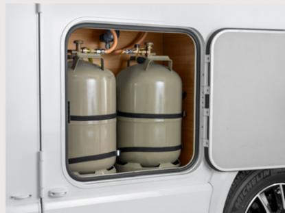
**Praktischer Längsgaskasten.** Für einen besonders einfachen Zugang und noch schnelleren Tausch der Gasflaschen verbauen wir einen Längsgaskasten. Dieser ist für zwei 11 kg Gasflaschen geeignet, die sich nebeneinander befinden (baureihenübergreifend).
