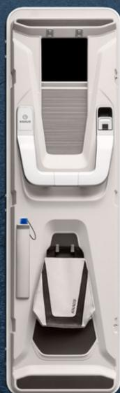
Die wetterfeste Doppeldichtung hält Schlagregen und andere Wettereinflüsse sicher draußen. Das automotiv Schließsystem ist besonders geräuscharm und hat eine Mehrfach-Verriegelung. Für mehr Helligkeit sorgt ein Fenster inklusive Verdunklungsplissee. Weitere Highlights: An der Tür sind eine multifunktionale Tasche im KNAUS Design für kleine Einkäufe und eine Regenschirm-Halterung angebracht (optional).
