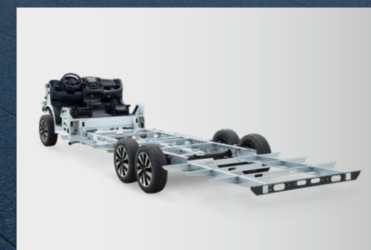
Der tiefe Schwerpunkt und das besonders verwindungssteife Chassis sorgen für hervorragende Fahr- und Komforteigenschaften sowie maximale Fahrsicherheit (modellabhängig).
