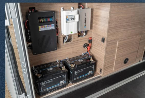
Bestens organisiert! Dank der zentralen Positionierung der gesamten Fahrzeug-Elektrik, wie hier beim VAN T1 in der Heckgarage, sind alle wichtigen Elemente leicht zugänglich & übersichtlich angeordnet. Das spart Zeit im Wartungsfall (modellabhängig).
