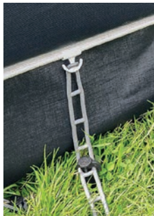
Variable Abspannung zwischen den Erdstreifen
